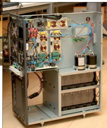
El sargento Ruiz comprueba la conexión del lector portátil del SSRL con el ordenador (arriba). Material obsoleto, revisado y pendiente, en los talleres (centro); sistema de alimentación ininterrumpida en reparación (abajo)
