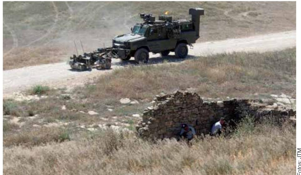
Detección de explosivos mediante el empleo de los rodillos del RG-31
