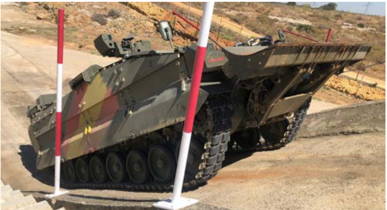
El prototipo tiene que ser capaz de subir pendientes de un 60% al máximo de carga (33 toneladas), y rampas laterales de hasta un 30%
