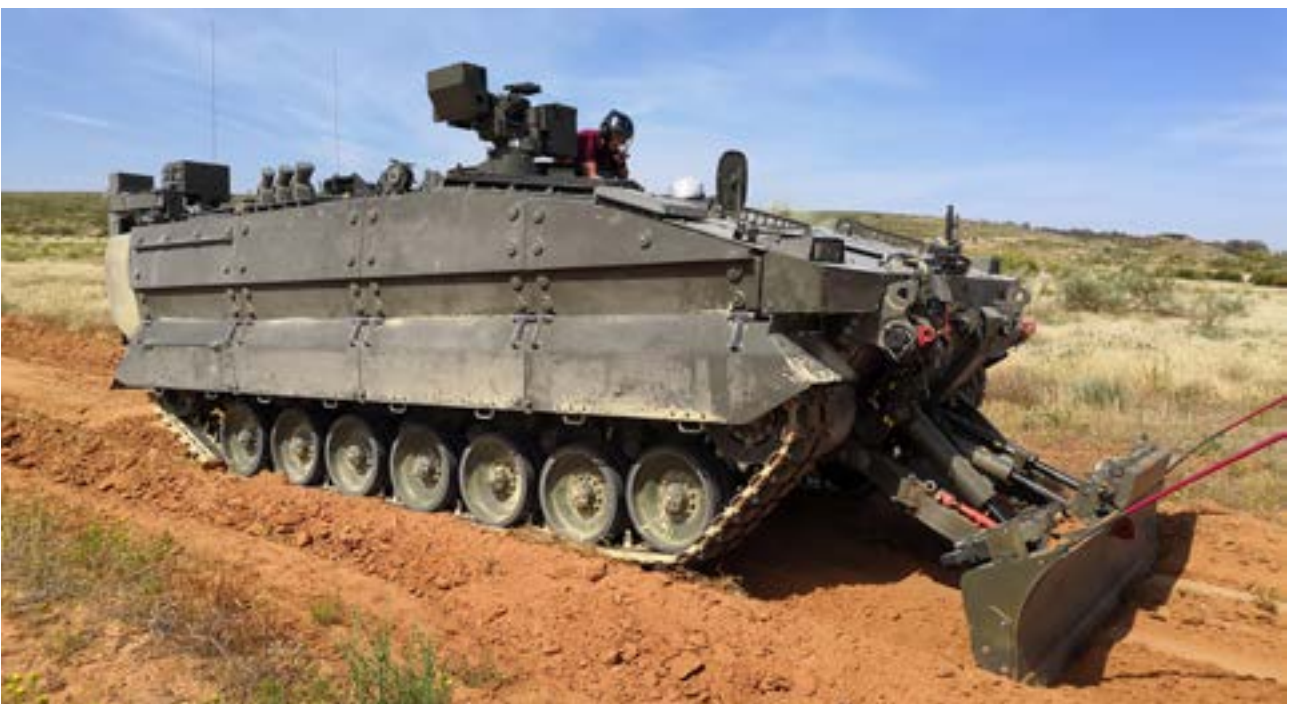
Los vehículos cuentan con diversos implementos: rodillo antiminas (en las páginas anteriores), arado (fotografía superior), pala (fotografía inferior) y marcador de obstáculos
