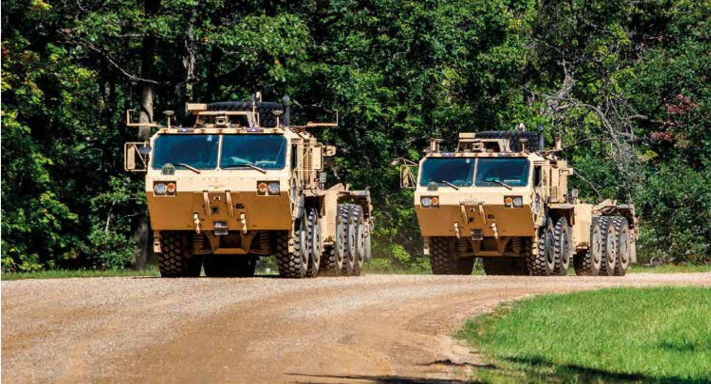
Camiones Oshkosh PLS (*Palletized Loader System*) equipados con Sistemas Autónomos
