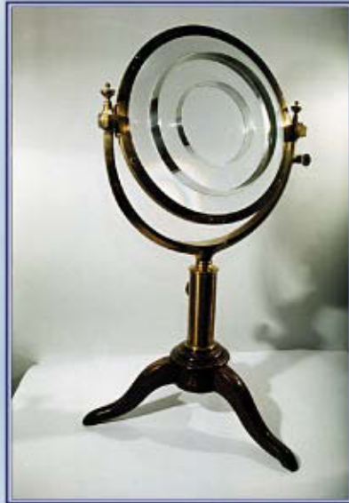
Lente de Fresnel utilizada en los faros marinos para conseguir un haz de rayos paralelos
