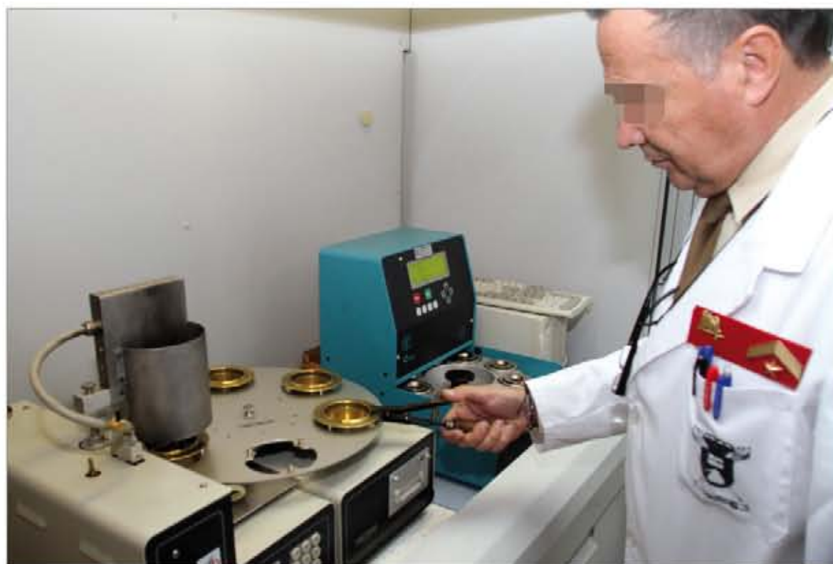
Preparado de muestras para el ensayo de determinación del punto de inflamación de lubricantes (arriba) y medición de una zapata de la cadena de un vehículo acorazado (derecha)
