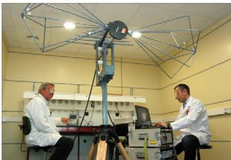
Máquina de carga directa para la calibración de células de carga (superior) e interior de la Jaula de Faraday para mediciones TEMPEST (derecha).
