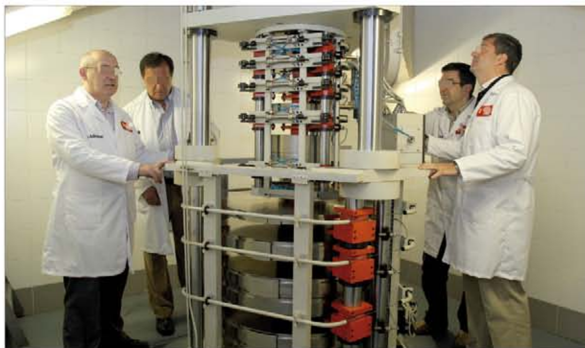
Máquina de carga directa para la calibración de células de carga (superior) e interior de la Jaula de Faraday para mediciones TEMPEST (derecha).
