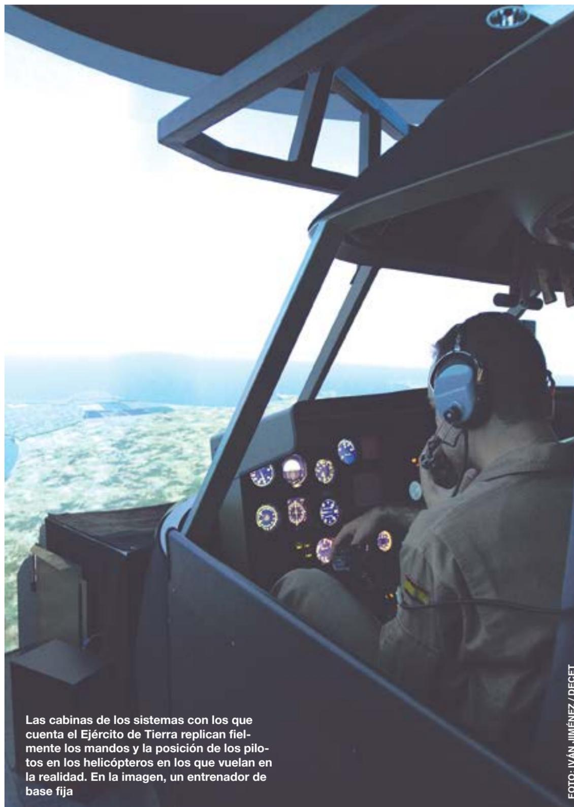
Las cabinas de los sistemas con los que cuenta el Ejército de Tierra replican fielmente los mandos y la posición de los pilotos en los helicópteros en los que vuelan en la realidad. En la imagen, un entrenador de base fija
