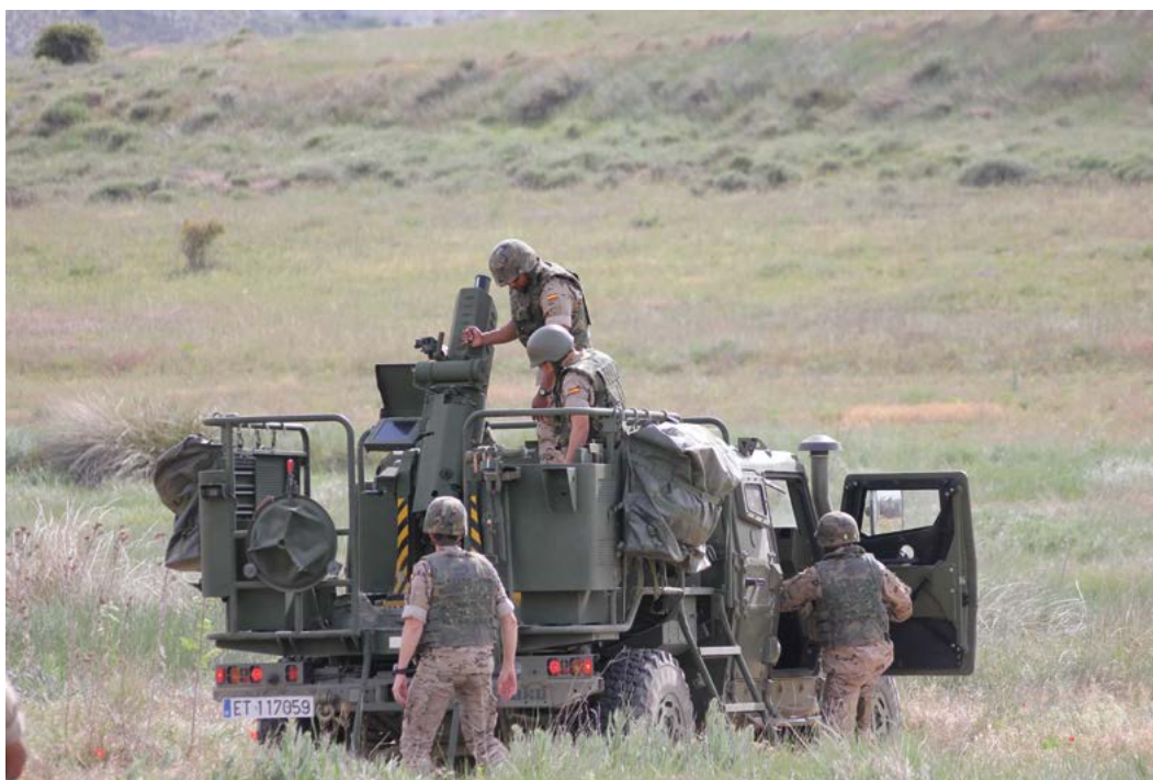
Mortero embarcado CARDOM sobre VAMTAC foto MINISDEF
