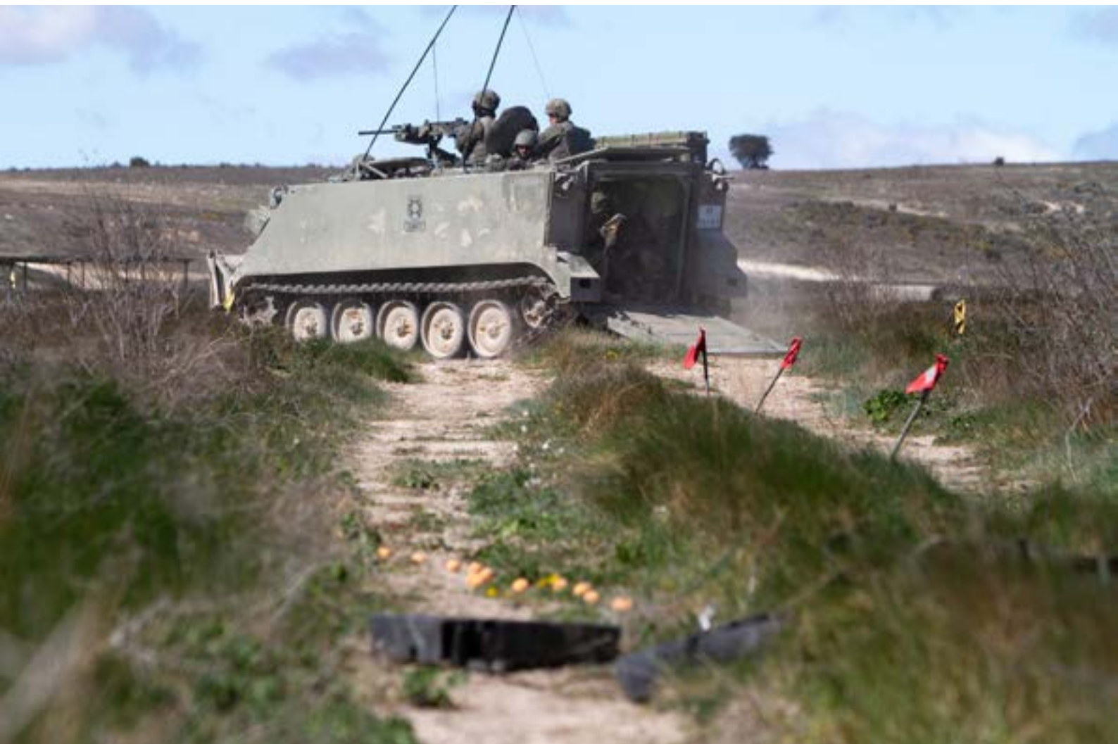
La brecha se jalona para que los vehículos sepan por dónde pueden avanzar de forma segura
