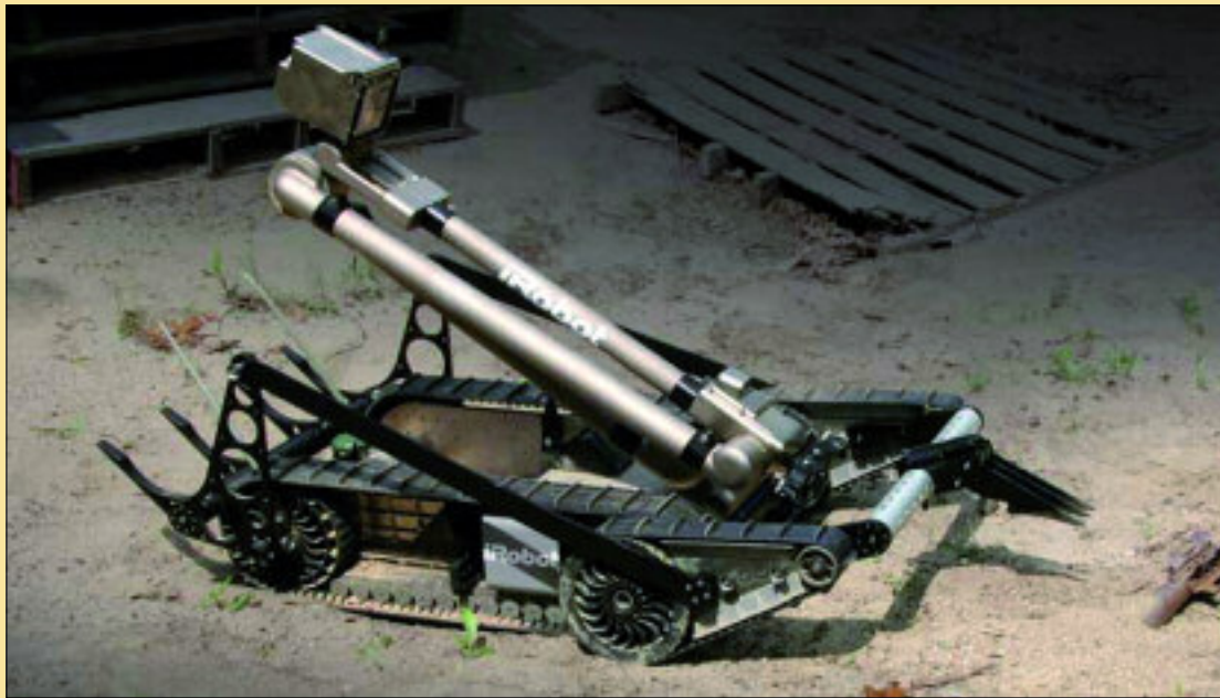
El iRobot tiene unas dimensiones más reducidas que el Teodor , por lo que puede acceder a más lugares
