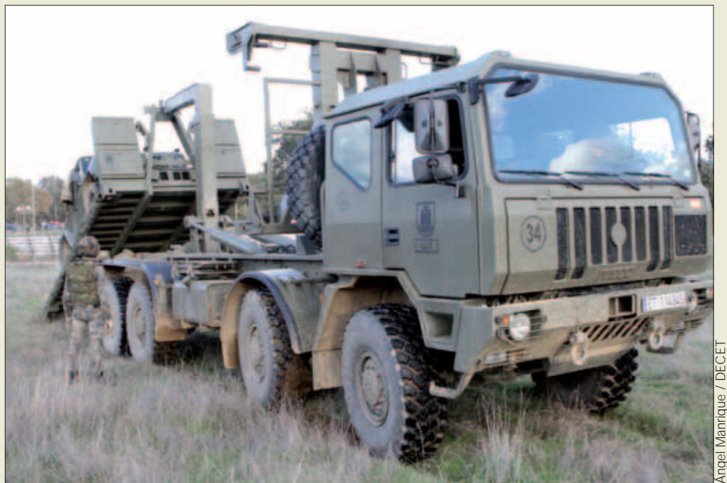
Personal de la ULOG practica la recuperación de un vehículo con el VEMPAR
