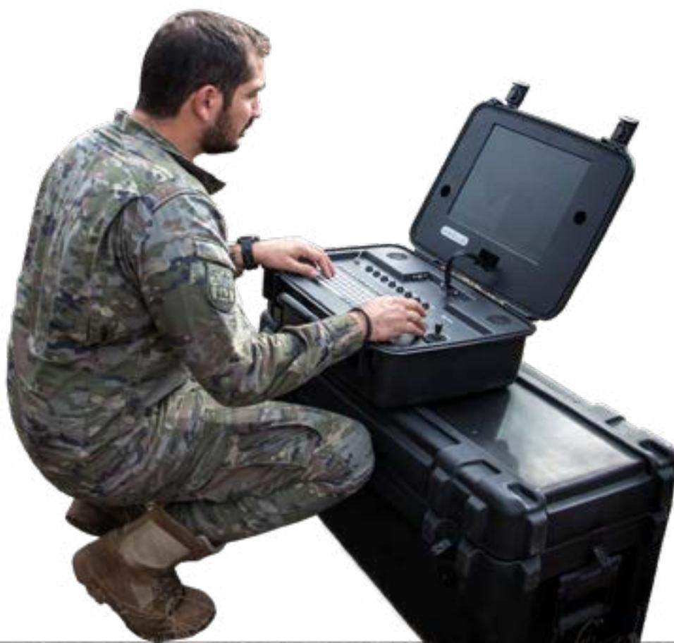
*El operador de misión controla la aeronave y la cartografía desde la estación de control terrestre*
