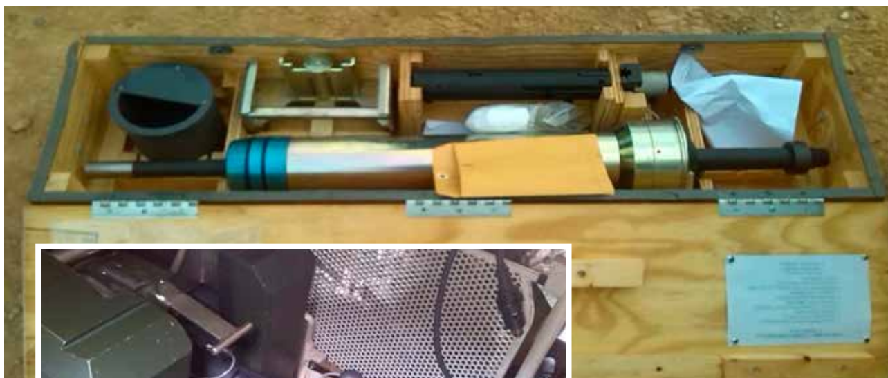
Subcalibre AIM TEST 12,70 mm (arriba) y detalle del cierre y el solenoide (izquierda).
