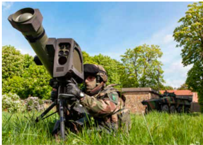
El MMP, de 15 kg, puede utilizarse como un arma portátil empleando un puesto de tiro portátil que pesa 11 kg.
