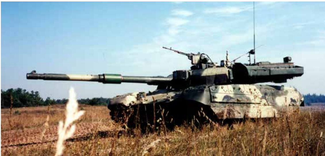
Para evitar la explosión de las municiones al recibir un impacto, el cargador automático del T-84-120 Oplot ucraniano fue colocado en la parte trasera de la torre.
