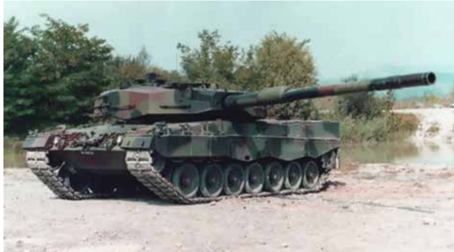
Leopard 2 suizo con cañón de 140 mm. Para aumentar la potencia de los cañones convencionales, al final no quedará más remedio que incrementar su calibre.
