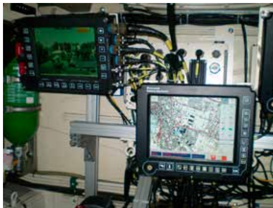
Hoy en día se exige que tanto los carros como los principales blindados dispongan de un sistema de gestión del campo de batalla o BMS.
