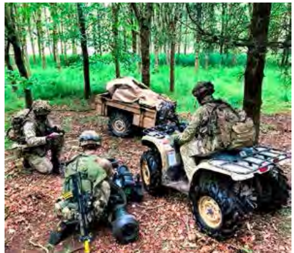
Empleo de quad con remolque para transportar un sistema contra carro « Javelin »
