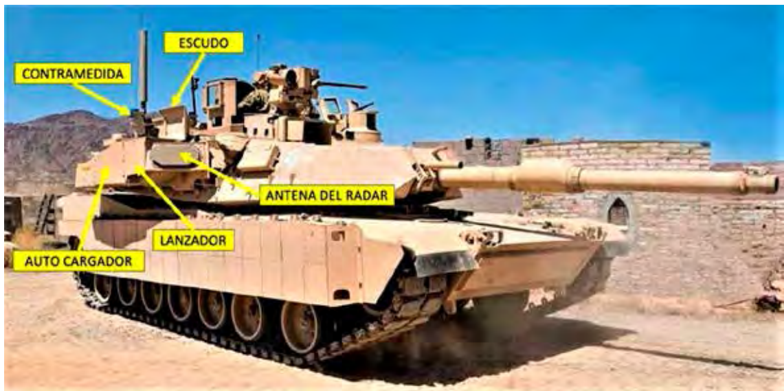
Detalle del sistema Trophy en el M1A2 SEPv2 Abrams
