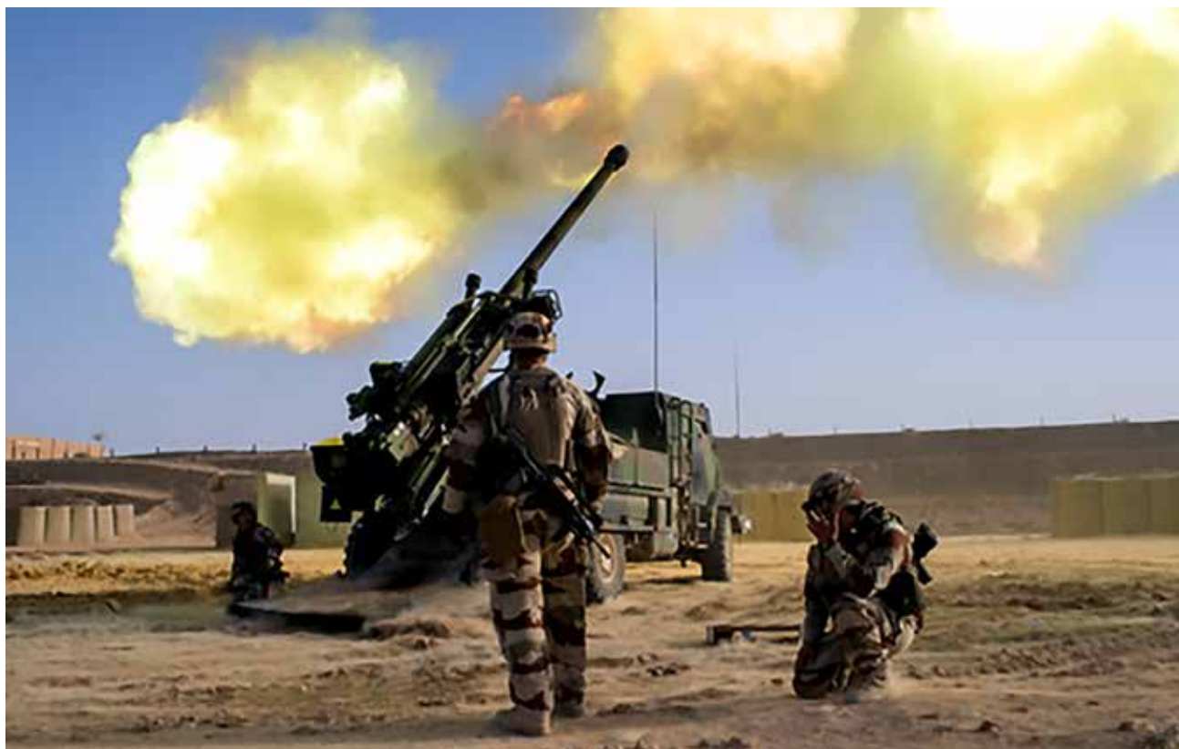
El CAESAR es un camión equipado con un sistema de artillería. Permite golpear con la potencia de una munición de 155 mm, a 40 km, con excelente precisión
