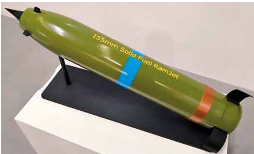
Proyectil de 155 mm con tecnología ramjet . Fuente: NAMMO Systems, 2019
